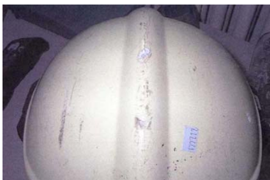
Abb.4 Eingeschnittene Fasern sind sichtbar. Die Helmschale ist unbrauchbar.
