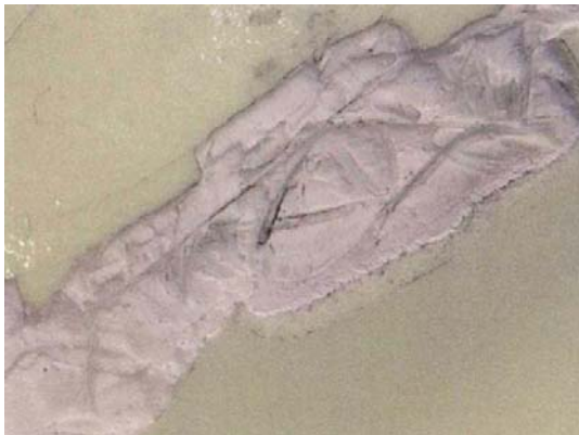
Abb.3 Stoßbeschädigung der Helmoberfläche, Prüfen auf Delaminierung.
