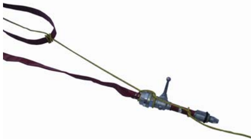
Abb. 2: Deutsches Einbinden mit „britischer Erweiterung“ am ersten Schlauch
