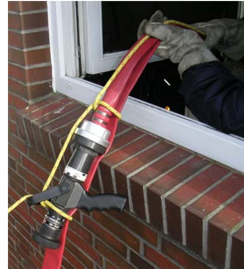
Abb. 5: „amerikanisches“ Einbinden mit Hohlstrahlrohr
