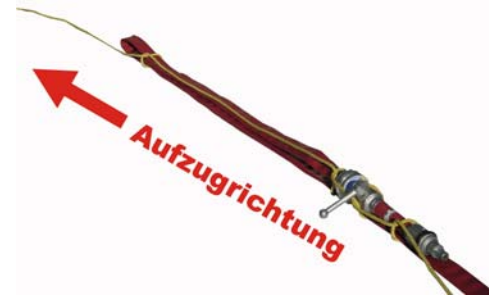
Abb. 6: „amerikanisches“ Einbinden mit CMM-Rohr
