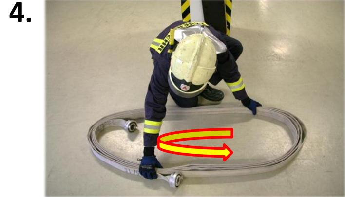
Schlauch gegen den Uhrzeigersinn ausdrehen, bis die äußere Kupplung am Wendepunkt liegt; Hohlstrahlrohr & eventuell 2C Verteiler anschließen (Strahlrohr ausrichten ggf. Schlauch mit Staubsauger entlüften)
