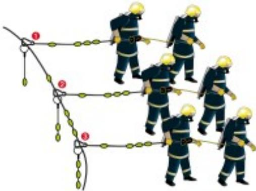
Die Abzweigringe sind aus schwer entflammablem PX700 Material hergestellt und verfügen über fluoreszierende Knoten. Diese dienen zur Kenntlichmachung der im Einsatz befindlichen Trupps oder von Kreuzungen beim Einsatz mehrerer Führungsseile z.B. in T-Form.
