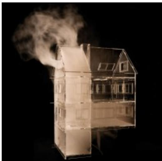
Zur Simulation von Durchschlägen sind die Etagenfußböden mit Riegeln ausgestattet. Um einen noch höheren Realismusgrad zu erreichen, kann man im Wohnhaus einen LED Brandherd legen. Mit den zwei Ventilatoren lassen sich die diversen Überdrucktechniken üben und studieren. Es ist mit Schiebefenstern und -türen für variable Abluft ausgestattet.
