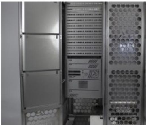
Der Serverschrank ist eine Erweiterung des Löschrainers Vesta für noch vielfältigere Übungsszenarien. Der Schrank ist mit vier Türen ausgestattet, zwei an der Vorderseite und zwei an der Rückseite. Mit dem eingebauten Flammentrichter lässt sich die Richtung der Flamme wählen.
