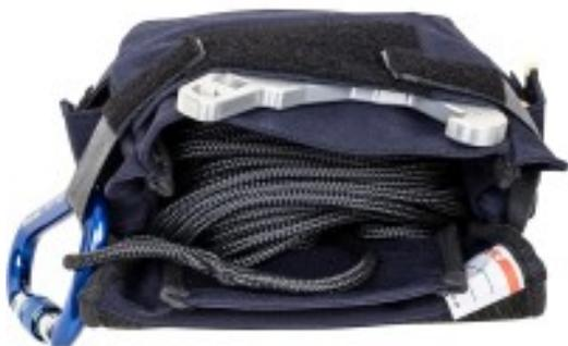
Hauptaugenmerk auf die Rückwegsicherung bei Nullsicht und das Auf-/Abseilen von Material gelegt. Hierfür ist eine 30 m Aramid-Leine (AS-06160) mit einer Bruchlast von 895 kg und einem Schmelzpunkt von 450° C vorgesehen, welche am Boden des Leinenbeutels durch einen Karabiner (SO-80270) fixiert wird. Der Auslauf der Leine ist in zwei Richtungen möglich. Klettflaschen verhindern das unkontrollierte Auslaufen. (die Standard-Feuerwehrleine 30 m passt NICHT in diesen Beutel)
