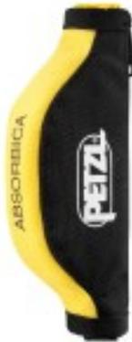
Das einfache ABSORBICA-I-Verbindungsmittel mit kompaktem Falldämpfer ist zur Fortbewegung an einem horizontalen Geländeseil (Textil- oder Drahtseil) oder auf einer Hebebühne ohne Passieren von Zwischensicherungen konzipiert. Es bietet mehrere Möglichkeiten der Befestigung am Gurt und kann mit unterschiedlichen Verbindungselementen verwendet werden. Das ABSORBICA-I ist entsprechend den verwendeten Verbindungselementen nach amerikanischen, europäischen und russischen Normen zertifiziert.
