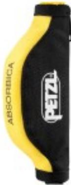
Das doppelte ABSORBICA-Y-Verbindungsmittel mit kompaktem Falldämpfer ist zur Fortbewegung an einer vertikalen Struktur oder an einem horizontalen Geländerseil und zum Passieren von Zwischensicherungen konzipiert. Es bietet mehrere Möglichkeiten der Befestigung am Gurt und kann mit unterschiedlichen Verbindungselementen verwendet werden. Das ABSORBICA-Y ist entsprechend den verwendeten Verbindungselementen nach amerikanischen, europäischen und russischen Normen zertifiziert.
