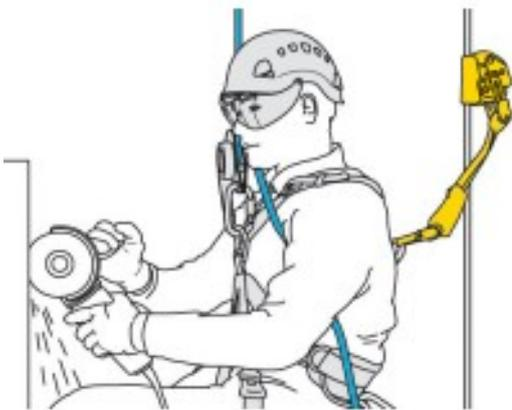
Der Falldämpfer ASAP'SORBBER ist ausschließlich für die Verwendung mit dem mitlaufenden Auffanggerät ASAP oder ASAP LOCK bestimmt. Er ermöglicht es dem Anwender entfernt vom Seil zu arbeiten, um es während der Arbeitsphasen zu schützen. Der Bandfalldämpfer befindet sich in einer Hülle, die an den Enden geöffnet werden kann. Der Falldämpfer wird so vor Abrieb geschützt und kann regelmäßig überprüft werden.
