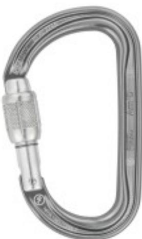
Die D-Form des asymmetrischen Aluminiumkarabiners Am´D eignet sich hervorragend zum Einhängen von Abseilgeräten und Verbindungsmitteln zur Arbeitsplatzpositionierung. Die kantenfreie Oberfläche an der Innenseite und das Keylock-System erleichtern das Ein- und Aushängen.
