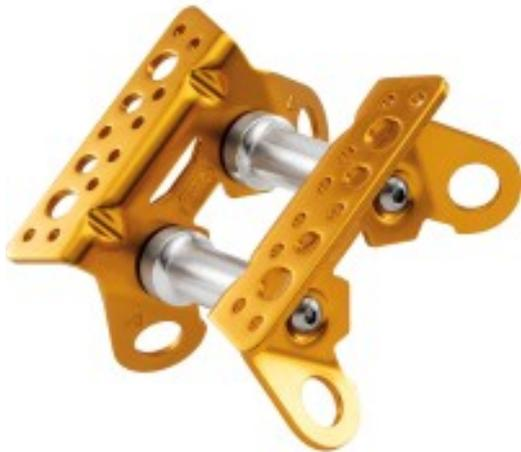
Der Seilschutz ROLLER COASTER schützt bewegliche Seile vor Abrieb. Durch zwei unterschiedlich geformte Seiten ist der Seilschutz beidseitig verwendbar. Er passt sich sowohl ebenen wie verwinkelten Flächen an. Die zahlreichen Verbindungsösen ermöglichen die Verwendung mit unterschiedlichen Befestigungssystemen. Es ist möglich, mehrere Module zu verbinden, um sich den unterschiedlichen Einsatzbedingungen anzupassen.
