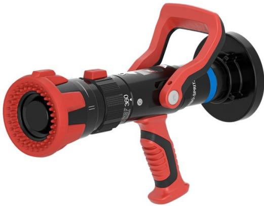
Die Turbo-Spritze EVO 750 ist ein Hohlstrahlrohr nach DIN EN 15182 Funktionskategorie 3 mit einstellbarer Strahlform bei wählbarer konstanter Durchflussmenge 360 / 550 / 750 l/min bei 6 bar. Die Turbo-Spritze EVO 750 ist zum Löschen im Außenbereich geeignet. Eine großzügige Durchflussleistung ermöglicht die Ausbringung von großen Löschwassermengen auf umfassende Brandherde, auch in der typischen Riegelstellung.
