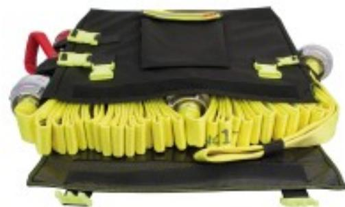
Die Variante Rotterdam ist die größere Ausführung der Schnellangriffstasche de Vries. Sie ist für die Aufnahme eines 30 m Druckschlauchs C42 oder zwei 15 m Druckschläuchen C42 ausgelegt.
