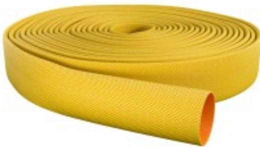
Vielseitiger und hochflexibler Flachslauch für den Geländeeinsatz aus spinndüsengefärbtem Spezialgewebe in der Farbe Gelb-Orange. Hergestellt aus 100% synthetischem Polyestergarn, rundgewebt in Köperbindung. Innenauskleidung aus speziellem und hochwertigem Polyurethan.
