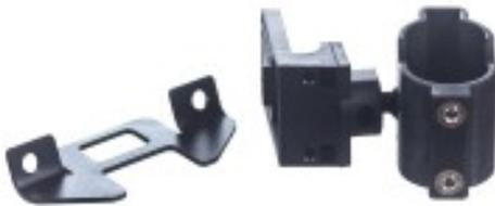
Die Helmmodelle Bullard H1500 und H3000 können einfach mit zusätzlichen Steckplätzen für Lampen nachgerüstet werden. Die Steckplatzerweiterung schafft den nötigen Platz. Sie wird einfach auf die vorhandene Visier- und Kinnriemenbefestigung aufgeschraubt. So lassen sich mittels eines Adapters Lampen schnell, einfach und unabhängig vom Visier an- und abbauen.
