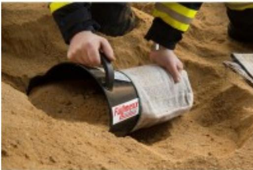
Mit dem Füllmexx lassen sich Sandsäcke einfach und ohne großen Kraftaufwand befüllen.
