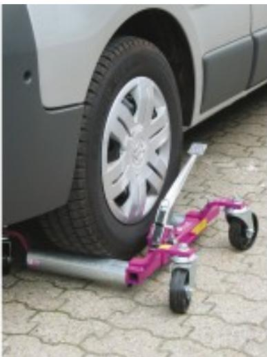
Die GOJAK-Rangierhilfe ist das optimale Hilfsmittel um Fahrzeuge, die nicht mehr aus eigener Kraft bewegt werden können oder die Rettungsarbeiten behindern, schnell und ohne großen Kraftaufwand zu verschieben.
