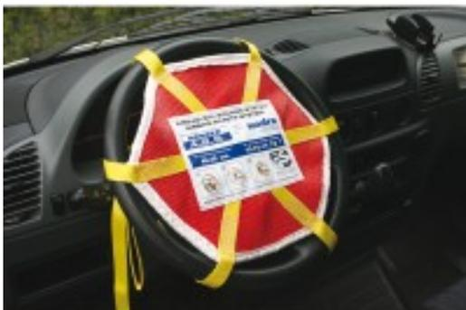
Dadurch dass das Sicherungs-System von der Seite über den Lenkradkranz gelegt werden kann und sich beim Zuziehen selbstständig zentriert, ist auch diese Phase risikolos für den Retter. Im Gegensatz zu Systemen aus Metall besteht keine Verletzungsgefahr, wenn der Airbag während des Anlegens auslösen sollte. Metallsysteme sind deswegen z.B. in den USA verboten.
