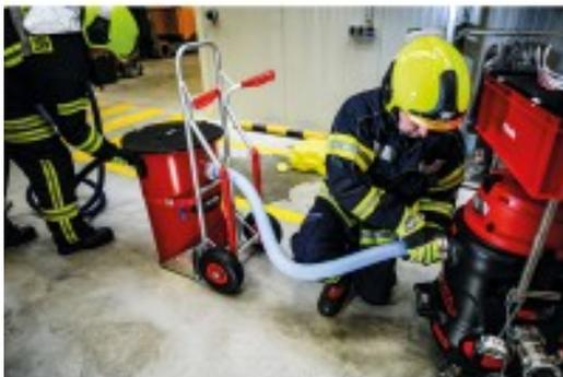
Wenn bei Einsätzen Materialien und Flüssigkeiten vor der Weiterleitung in Kanalsysteme oder in Gewässer gereinigt und gefiltert werden sollten, ist der Vorabscheider ULTRA die ideale Ausrüstung für die Feuerwehr.
