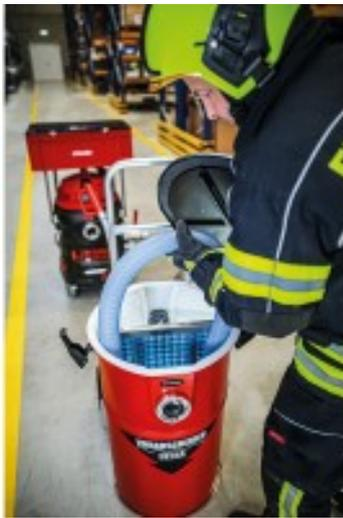
dem Schwammfilter werden grobe Partikel aufgehalten bevor Sie zum Feuerwehrsauger gelangen. Verstopfungen in der Absaugereinheit des Saugers werden somit effektiv vermieden.
