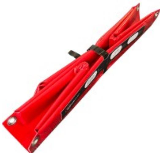
Die Auffangwanne ist freitragend, gefertigt aus PVC mit einer speziellen Oberflächenbeschichtung (PES/PVC 680 g/m<sup>2</sup>). Das Material ist beständig gegen Erdölprodukte und Säuren. Die Stabilität wird durch verschweißte Ecken und Verstärkungen aus Polypropylen an den Oberkanten der Wanne gewährleistet. Der Temperatureinsatzbereich der Wannens liegt bei -30 °C bis +70 °C. Die Auffangwanne ist für den Innen- und Außenbereich geeignet. Nach der ökologischen
