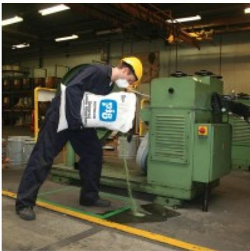
PIG FIRE-DRI ist ein pflanzliches Absorptionsmaterial aus harzhaltigem Holzmehl, das bei hoher Temperatur getrocknet und verarbeitet wird um feuerbeständig zu sein. Das Streumittel absorbiert Öle, Kühlmittel, Lösungsmittel und Wasser.
