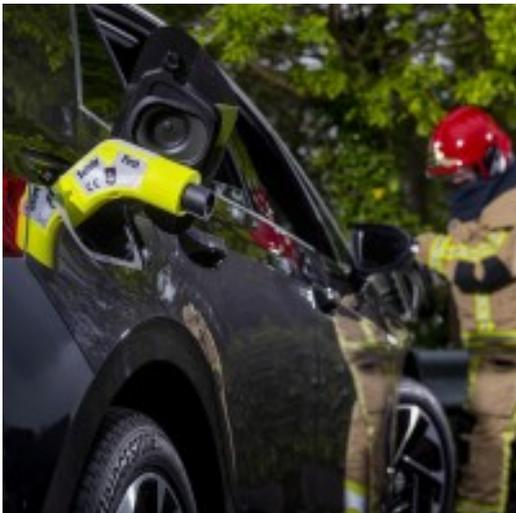
ziehen die elektrische Parkbremse an. Das Auto steht sofort sicher an seinem Platz und die Rettungskräfte können sicher arbeiten! Der Emergency Plug zeigt über LEDs den Status an, so ist sofort erkennbar ob das Fahrzeug deaktiviert wurde.
