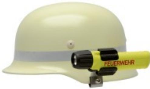
Die Halterungen für Helme nach DIN 14940 werden einfach über die untere Kante des Helmes geschoben und sind daher universell passend für alle Helme mit geradem Rand. Mit einer Schraube wird der Halter dann fixiert. Je nach Modell schützt eine Gummipatte nochmal zusätzlich vor Beschädigungen.
