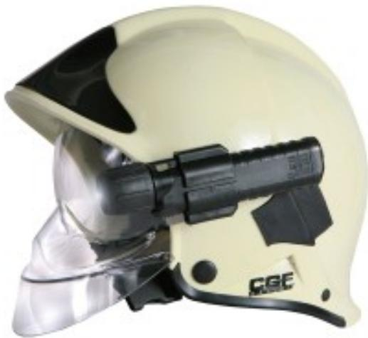
Sehr stabile Helmhalterung aus Edelstahl und Kunststoff, speziell für Gallet A2-Helme. Befestigung an vorhandener Schraube. Ideale Position der Lampe unmittelbar in Augenhöhe, so ist der Lichtstrahl immer optimal ausgerichtet. Höhenverstellung der Lampe durch einfaches Verdrehen. Durch die neue Pulverbeschichtung erfüllt die Halterung die Vorgaben der EN 443:2008.
