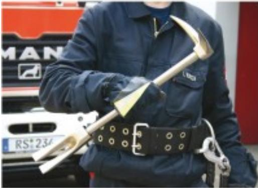
Multifunktions-Brechwerkzeug, zum Aufbrechen von Türen, Fenstern usw. Einsetzbar als Brechstange und Nageleisen, zum Spreizen und Einreißen. Hergestellt aus gehärtetem Stahl mit verchromter Oberfläche und geriffelten Griffen. Mit Hebelklaue - ideal für alle Aufbrecharbeiten.
