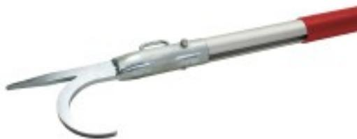
Der Einreißhaken (Teleskoprohr und Haken) hält einer Zugkraft von 2,5 kN in Längsrichtung stand. Alle Verbindungen werden mit unverlierbaren und ohne Werkzeug zu bedienenden Schrauben arretiert und gesichert. Der Teleskopstiel ist mit einem rutschfesten Griff- und Kälteschutz versehen, der gleichzeitig gegen Spannungen von mindestens 1000 V isoliert.
